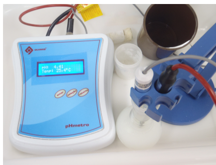
Figura 4. Equipamento utilizado para a determinação do pH
