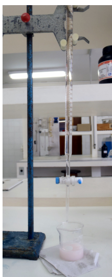
Figura 5. Titulação da amostra com solução de hidróxido de sódio 0,1 N
