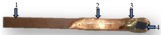
Figura 1 – Eletrodo de DDB: (1) placa de cobre; (2) isolamento do contato elétrico com resina epóxi Araldite ® ; (3) contato elétrico (liga estanho/chumbo) e (4) filme de DDB
