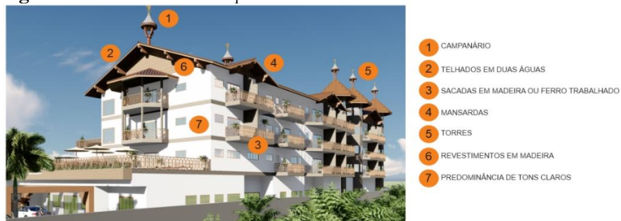
Figura 08 – Elementos da arquitetura austríaca utilizados no hotel
