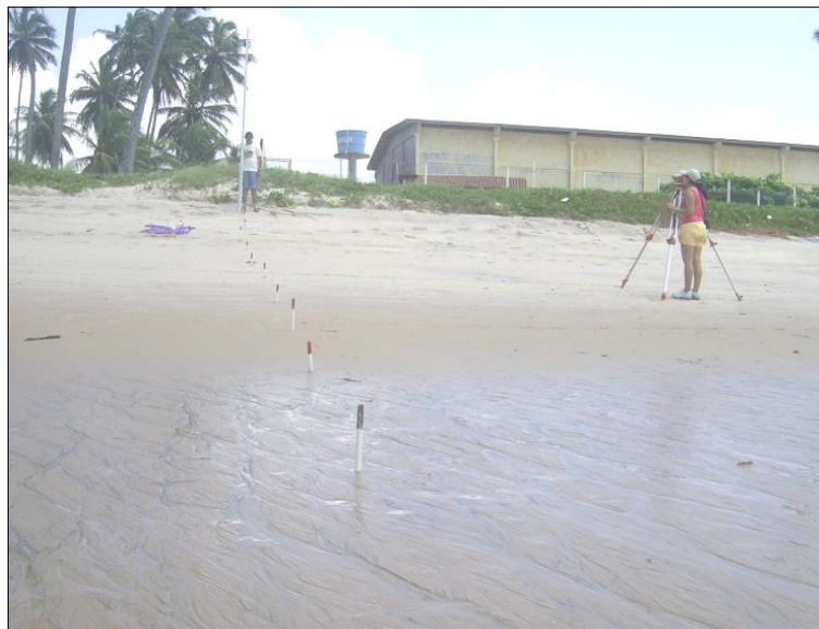
Figura 06 – Nivelamento topográfico no perfil P-02, situado na praia do Seixas. Foto: Severino R. A. da S. em agosto de 2007.
