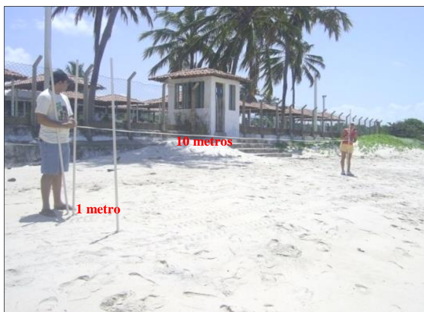
Figura 09 – Posição dos canos para medição da velocidade e direção da corrente litorânea. Foto: Severino dos R. A. da S., em junho de 2007.
