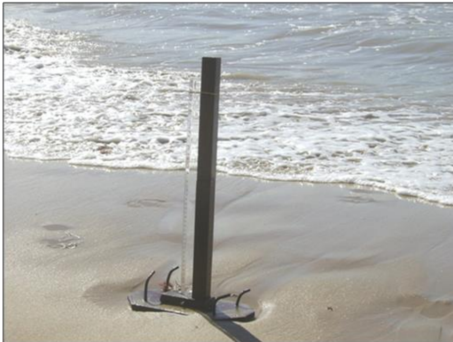
Figura 08 – Imagem do ondímetro instalado na linha de água. Foto: Cláudia S. V. Silva, em junho de 2007.
