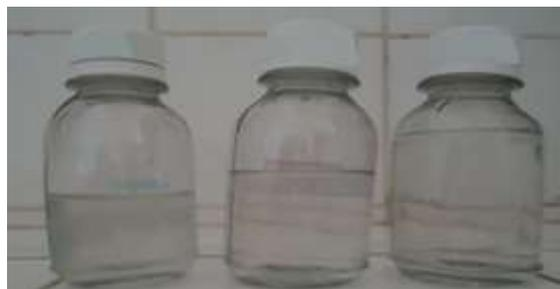
Figura 14- Vinhaça clarificada tratada com 5g/L, 10g/L e 15g/L de  $Al_2SO_4$ , após adsorção com carvão ativado.
