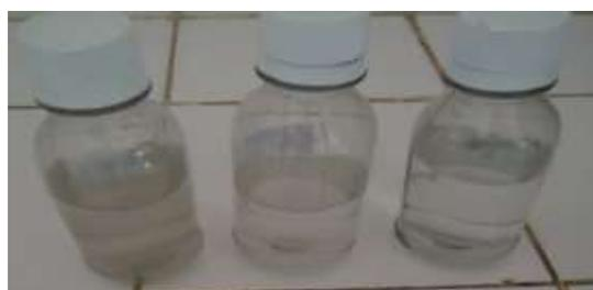
Figura 12- Vinhaça clarificada tratada com 5g/L, 10g/L e 15g/L de CaO, após adsorção com carvão ativado.
