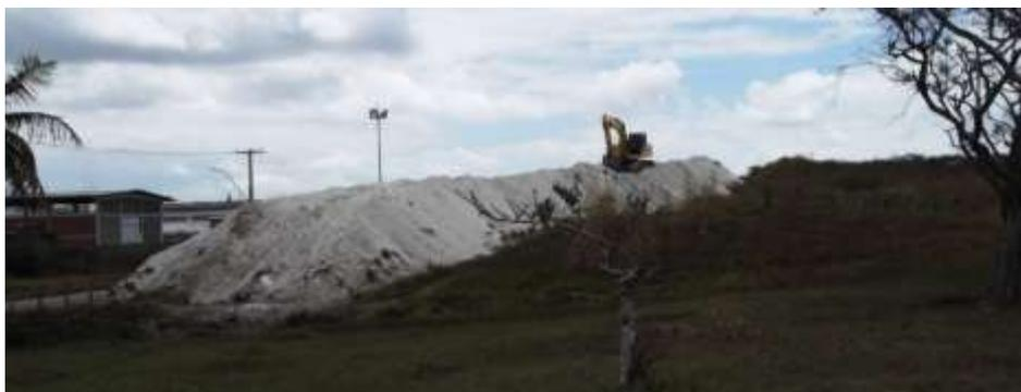
*Figura 1 – Pátio de uma empresa mineradora do estado da Paraíba, onde o resíduo do beneficiamento de caulim é depositado sem qualquer tratamento ou imobilização.*
