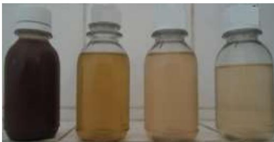
Figura 13-Vinhaça in natura, vinhaça clarificada com 5g/L, 10g/L e 15g/L de  $Al_2(SO_4)_3$ .
