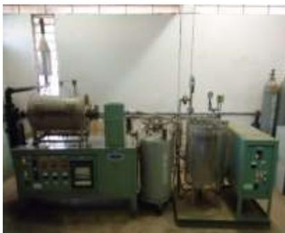
Figura 1. Forno Elétrico Rotativo
