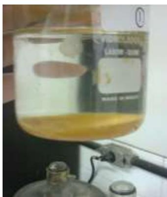
Figura 6: Vinhaça após o tratamento com o processo Fenton.
