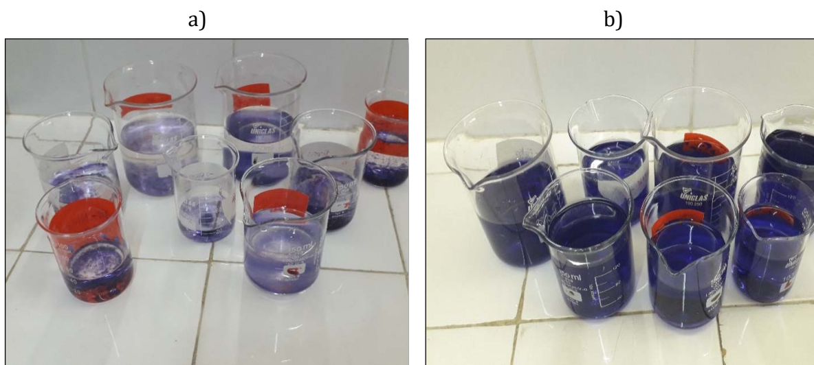
Figura 3 – Amostras antes (a) e após (b) o processo eletrolítico
