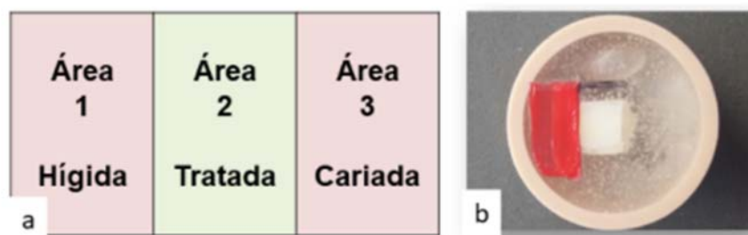
Figura 2 - a. Desenho esquemático da distribuição da amostra em áreas de análise; b. Amostra após o polimento e medição inicial da microdureza superficial, tendo a área controle recoberta com dupla camada de esmalte de unha. (Fonte: Autores)
