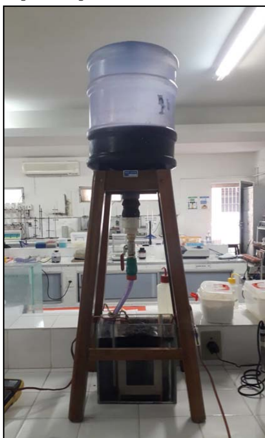
Figura 2 - Registro fotográfico: Sistema eletrolítico em fluxo contínuo
