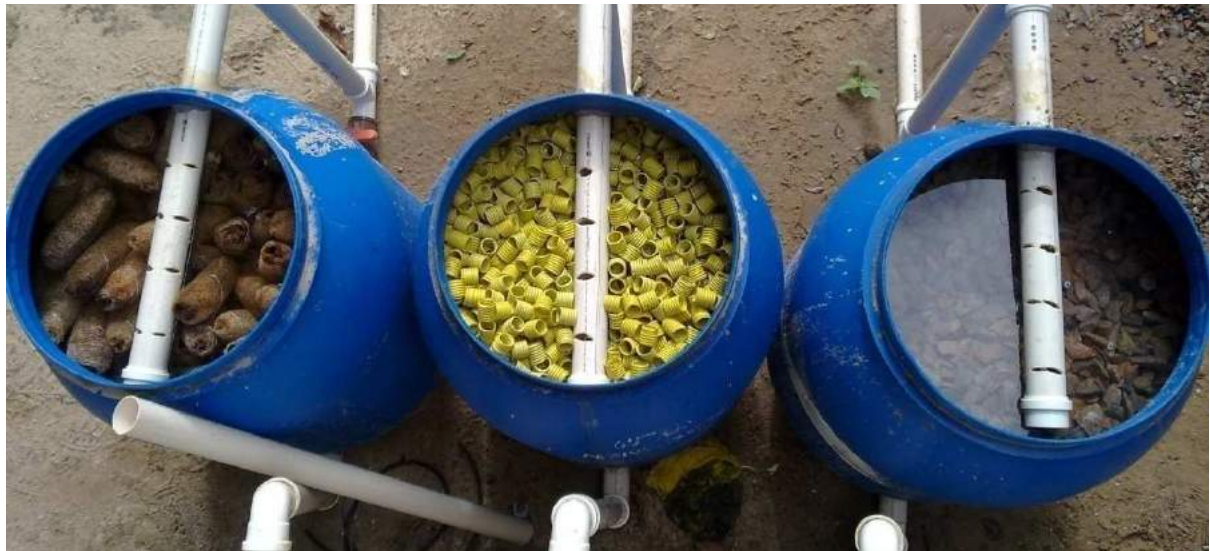
Figura 4 - Vista Superior. Da esquerda para direita: Bucha vegetal (F1), Eletroduto (F2) e Brita 32 mm (F3)
