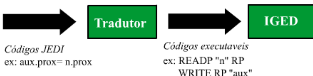
Figura 1 - Estrutura do como o tradutor JEDI recebendo o código em alto nível, traduzindo o código para o nível intermediário e o utilizando como entrada para o IGED.
