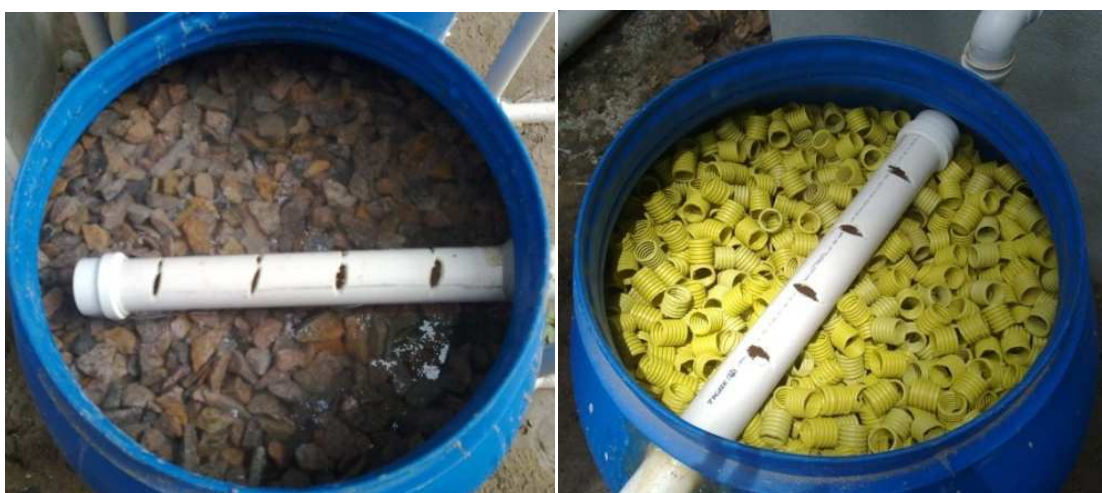
Figura 7 – F2 (com aparas de eletroduto) e F3 (com brita 32 mm)
