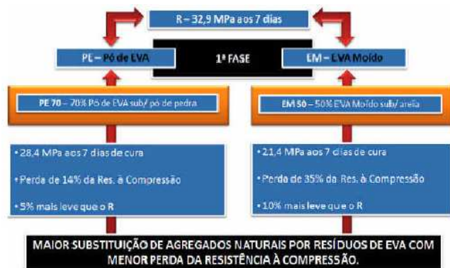
FIGURA 13: Resumo dos melhores resultados da 1ª fase e definição dos limites de substituições.
