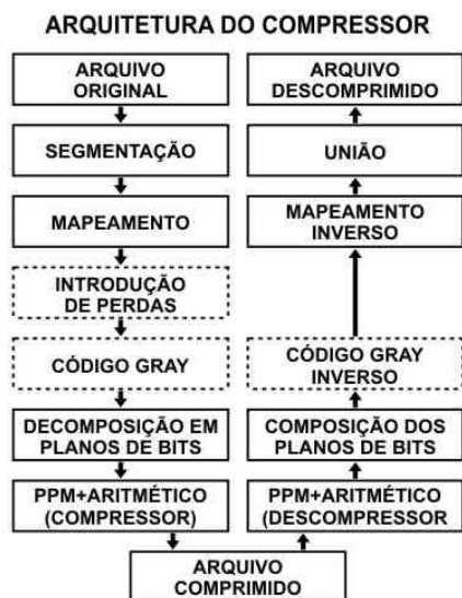
Figura 2: Arquitetura do Sistema de Compressão.
